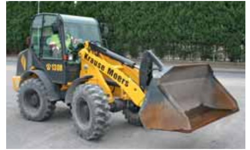
Der Kramer-Radlader vom Typ 418 ist mit Schaufel oder Stapleraufsatz bestückbar.
