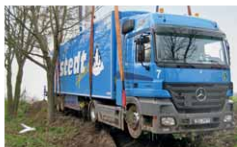
Ein eigens entwickeltes System leitet die Hebekräfte in die Lkw-Achsen ein.
