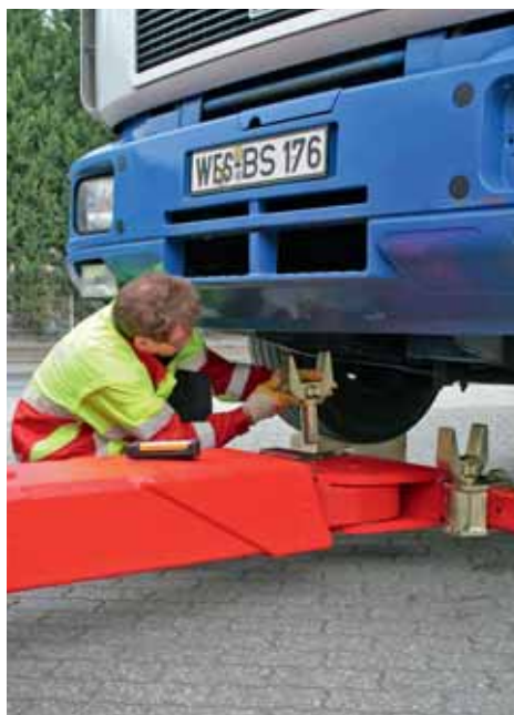
... vier Meter ausfahrbare Tragarm mit den Hubgabeln unter die Achse manövrieren.
