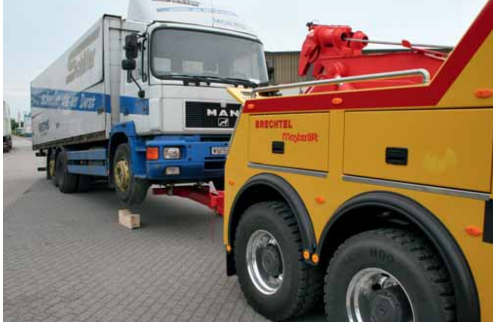
Da die gekröpfte Achse des MAN 26.272 tief baut, ist fürs Abschleppen des Lkw ...
