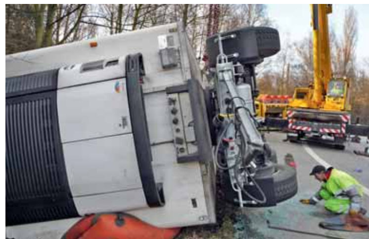
Das Bergungsgeschirr wird über spezielle Halter an den Rädern fixiert.
