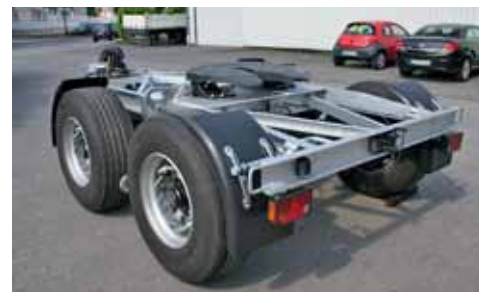
Auch der blattgedeferte Dolly ist ein Eigenbau. Seitlich sind Anschläge für Gurte ...
