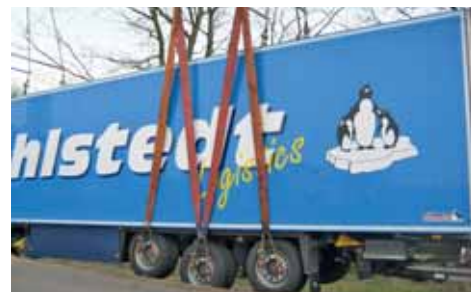
Das Bergungsgeschirr wird über spezielle Halter an den Rädern fixiert.
