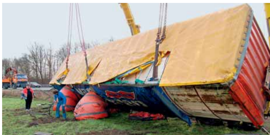
Glimpflich Ende: Oft lässt sich der Trailer so aufrichten, dass das Ladegut keinen größeren Schaden nimmt.
