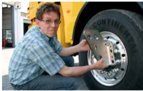
Krause setzt einen Radnabenhalter ein, an dem das Bergungsgeschirr befestigt wird.
